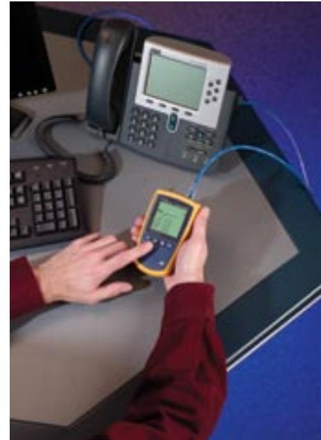
обнаруживать местоположение практически любого кабеля или пары проводов независимо от его применения. Используйте цифровой режим для обнаружения высокочастотных кабелей передачи данных (кат. 5е/6/6а) в жгутах, коммутаторах, коммутационных панелях или стенных розетках. Используйте аналоговый режим в телефонных кабельных системах (категория 3 и ниже), а также в коаксиальных системах, системах охраны/сигнализации и оповещения.
